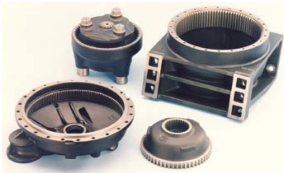
2: Verschiedene Bauteile für den Mischerantrieb eines Betonmischerfahrzeugs. Werkstoffe: EN-GJS-500-7 und EN-GJS-700-2 (partiell im Bereich der Verzahnung induktiv gehärtet).
