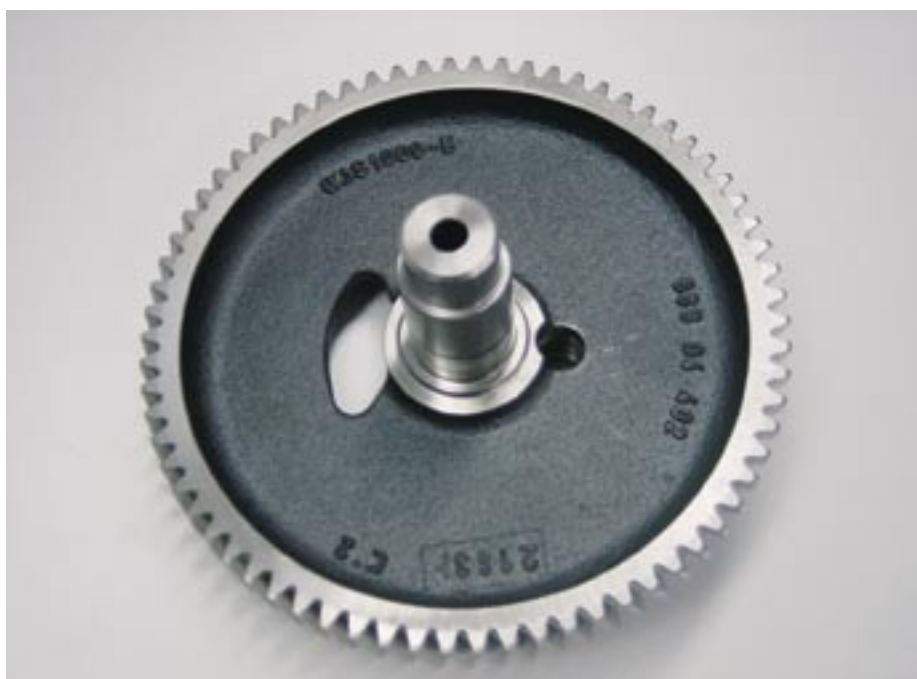
3: Antriebsrad für einen Bodenverdichter – aus Gründen der Geräuschreduzierung aus ADI (EN-GJS-1000-5).
