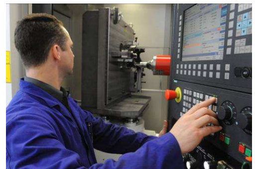
Mechanische Bearbeitung bei CLAAS GUSS: Horizontale Bearbeitungszentren Hüller Hille NBH 630 mit Palettenwechsel (Technische Details siehe nächste Seite.)
