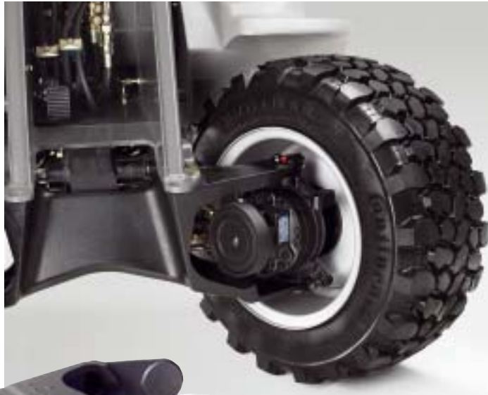
Überlegenheit des Finalprodukts durch Verwendung eines Eisengussbauteils kleines Bild: gegossene Achse eines Miniladers großes Bild: Einbausituation
