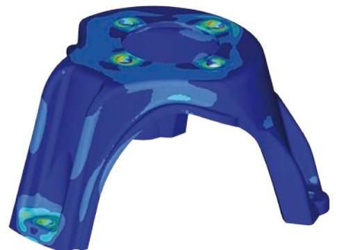
Bild 1: Sockel für Hydraulikmotor: Freiformkonturen ermöglichen ein gleichmäßig niedriges Spannungsniveau im Bauteil
